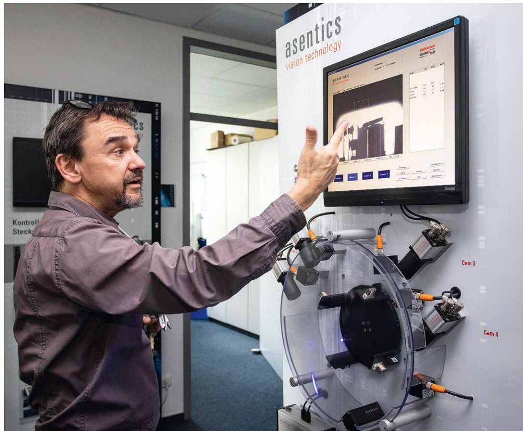
**10 Die Schnittstelle** – Asentics Vario macht Maschinen mit einer herstellerübergreifenden Kommunikation per OPC UA fit für Industrie 4.0.
